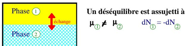
**Figure VIII-6 : Système hétérogène à deux phases**
